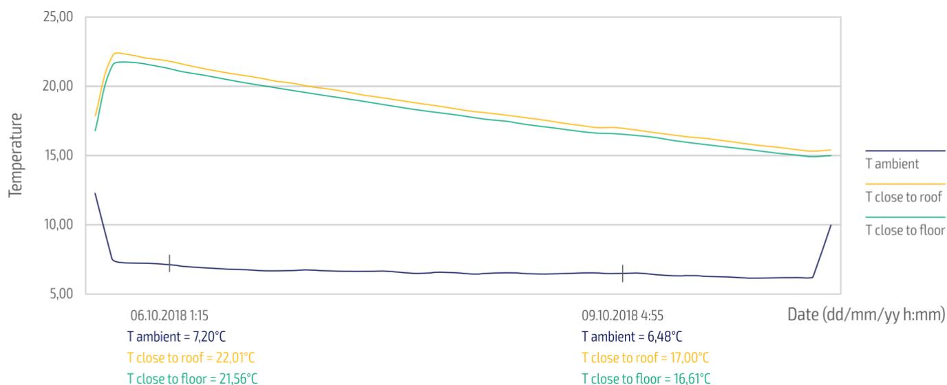
Температура груза понизилась на 5° С при разнице температур  $\Delta T = 20^\circ \text{C}$  за 75 часов 40 минут.
